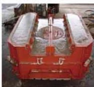
③コテ均し、養生
