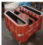
①型枠組立
