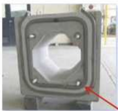
供試体の断面 高弾性接着剤 (TBボンド)
